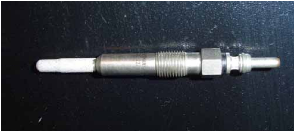
Rys. 1. Podgrzewacz z warstwą katalityczną Fig. 1. Starting heater plug with catalytic coating
