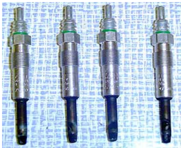
Rys.2. Widok podgrzewaczy rozruchowych po badaniach Fig. 2. Starting heater plugs after reserch
